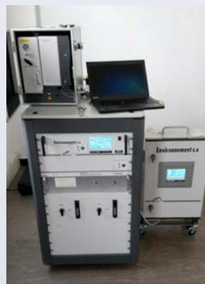
Baies d'analyses et chromatographe en phase gazeuse portable
