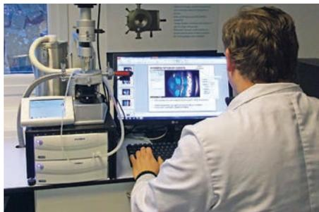
Grâce au microscope à lyophilisation Lyostat, un chercheur peut déterminer précisément la température d'effondrement d'un produit.
