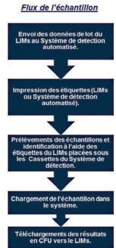
Fig. 2: Exemple de flux d'un échantillon lors de l'intégration LIMS avec une méthode rapide automatisée.
