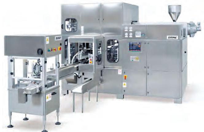
Fig. 1- Machine de remplissage aseptique BFS pour le PEBD – PEHD – PP pour seringues pré-remplies et vaccins.
