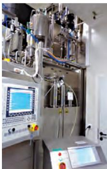
Contrôle d'intégrité du filtre de sécurité sur BFS.
