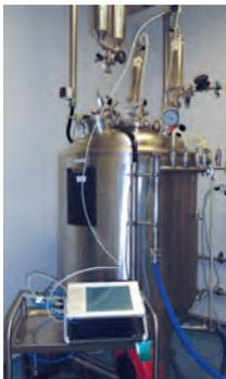
Contrôle d'intégrité du filtre de sécurité sur cuve de stockage
