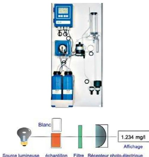
Figure 12 : analyseur d'ozone par spectrophotométrie avec son principe de mesure
