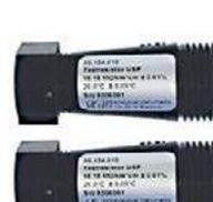
Photo 2 : exemple de résistances de test, certifiées
