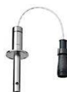
Photo 1 : exemple sonde de conductivité débranchable
