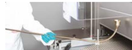
Illustration 2. Dans la méthode de contrôle actuelle, l'opérateur doit guider la sonde, qui est fixée à une tige, avec précision et à une vitesse exacte sous le filtre.)
