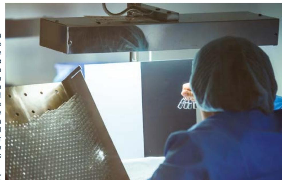
Plus concrètement, la défauthèque est une base de données physique regroupant des objets présentant des défauts bien décrits et caractérisés. Elle peut être utilisée pour la formation du personnel<sup>(1)</sup> réalisant l'activité de mirage manuel ou semi-automatique. Dans le cas du mirage automatique ou semi-automatique, elle servira de référence pour le réglage et la qualification des équipements.
