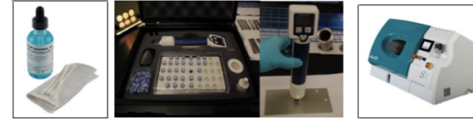
Figure 1 : Images illustrant, de gauche à droite, le kit de test au sulfate de cuivre, le kit du dispositif portable électrique, le stylo-sonde électrique et le caisson à brouillard salin automatisé
